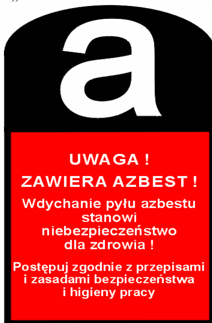
Rys. 16. Wzór oznakowania – pomieszczenie zawiera azbest
